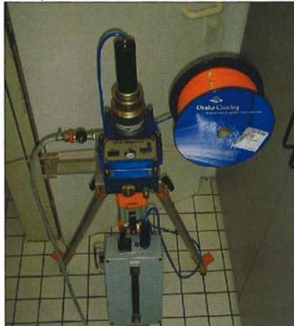
Fig. 6 - Injeção do cabo
